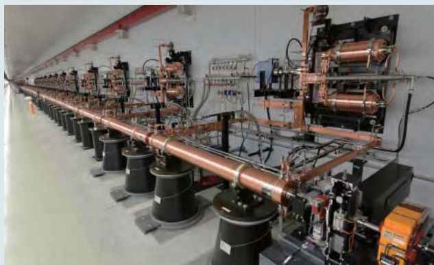
●電子の加速能力を従来の約2倍にするCバンド加速器(サクラ) 加速した高品質な電子ビームはアンジュレータに送られる。
