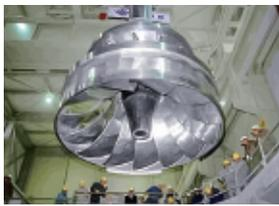
水の圧力と速度をランナーと呼ばれる羽根車に作用させる構造の水車で、広い範囲(10~300メートル程度)の落差で使用でき、日本の水力発電所の約7割がこの水車です。
