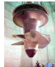
水の圧力と速度を利用します。落差が比較的低く、しかも流量が多い発電所で採用されます。羽根の角度を変えることができるものを「カプラン水車」と呼んでいます。
