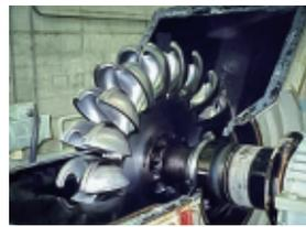
水の速度のみを利用する水車で、落差の大きい発電所に用いられます。ノズルから強い勢いで吹き出す水をおわん形の羽根に吹きあてて回転させます。
